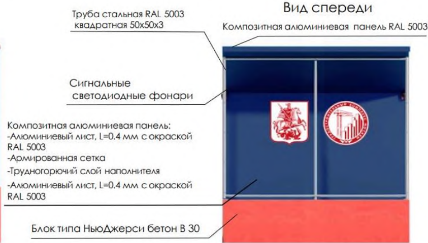
Тип 2.4 Защитно-охранное ограждение с пешеходной галереей
