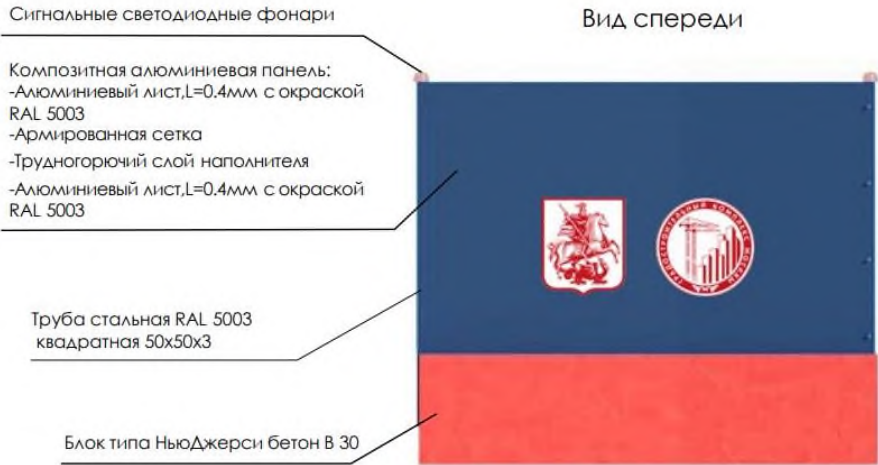
Тип 2.1 Защитное ограждение на проезжей части
